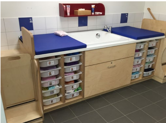
Abb. 38 Ergonomisch und sicher: ein Wickeltisch mit zugangsgesicherten Aufstiegshilfe, Aufkantung und Fußfreiraum.
